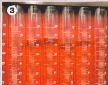
Die jeweiligen Einspritzmengen werden in der Ist-Aufnahme genau protokolliert und dienen später zum Vergleich
