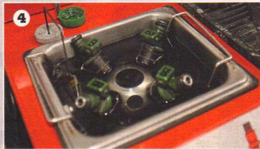
Im Ultraschallbad werden die teilzerlegten Einspritzventile mit einer Reinigungsflüssigkeit gründlich gesäubert
