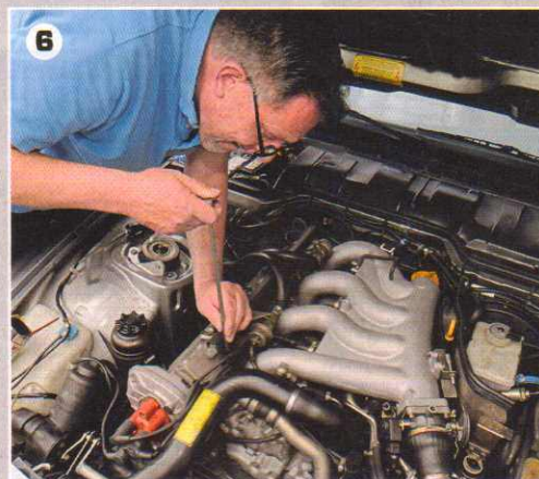
Reiner Telkamp setzt die vier Einspritzventile wieder ein und der Motor des Porsche 944 turbo schnurrt jetzt wie ein zufriedenes Kätzchen
